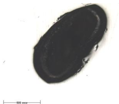
Газовая, одиночная, макропора. Сталь Св-30ХГСА. Без ВДУ, в объеме заготовки
