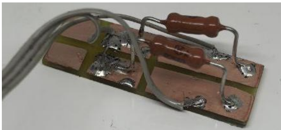
Рис. 1. Схема экспериментального исследования паразитной тензочувствительности тензоусилителя: а – чип-резисторы, б – выводные резисторы
