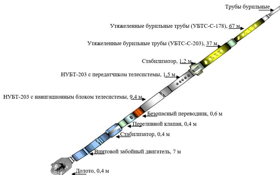
Рис. 1. Принципиальная схема компоновки низа буровой колонны
