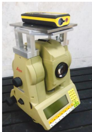
Рис. 3. Лазерный дальномер закрепленный установлен на эталонном дальномере с помощью приспособления для поверки дальномеров лазерных
