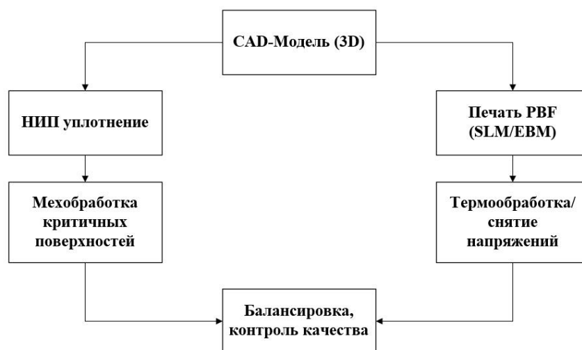
Рис. 3. Типовая технологическая цепочка изготовления РК из Ti-6Al-4V (PBF) с постобработкой
