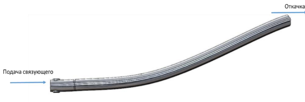
Рис. 5. Схема подачи и откачки связующего
