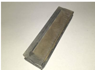
Рис. 3. Шлиф образца из хромоникелевой стали 12Х18Н10Т с наплавленными участками WC
